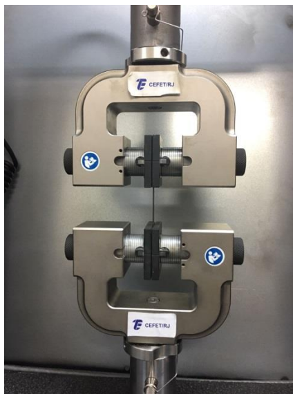
Figura 34 Posicionamento dos corpos de prova na máquina
