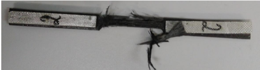
Figura 61 Corpo de prova após usinagem, com fibras se projetando para fora do material
