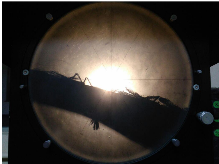
Figura 56 Área de ruptura de fibras no CP utilizado, analisada em um projetor de perfil
