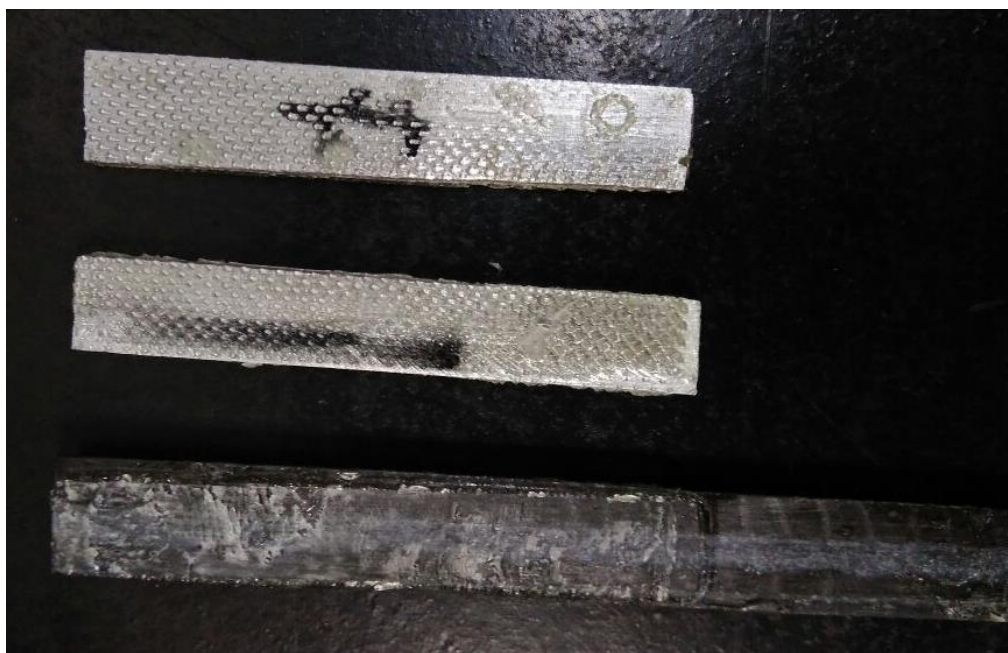
Figura 46 Extremidade do CP01 com orientação de fibra a 0^\circ , mostrando o deslizamento do corpo de prova e a falha nos tabs
