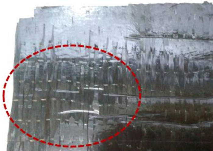
Figura 18 Região de pouca saturação das fibras na placa desenvolvida pelo grupo de aeromodelismo do CEFET/RJ
