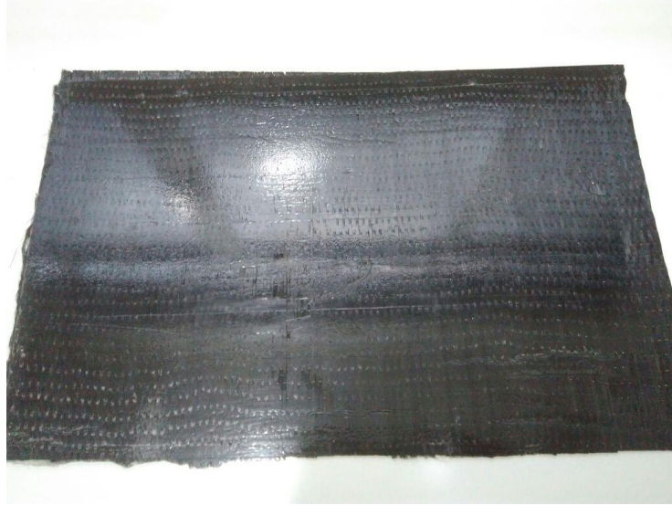
Figura 17 Placa de material compósito epóxi/carbono unidirecional fornecida pelo grupo de aeromodelismo do CEFET/RJ
