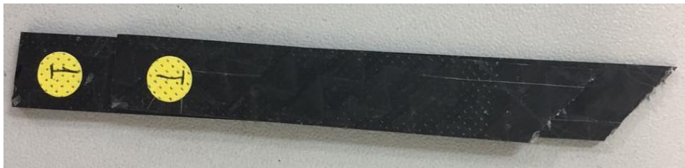
Figura 37 CP01 com orientação de 45°, após término do ensaio.
