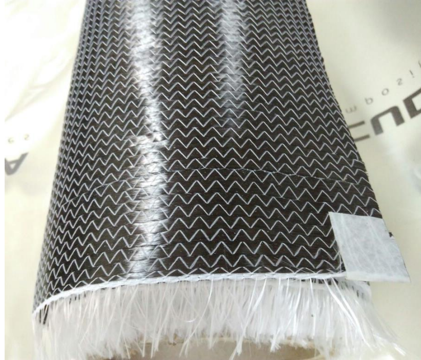
Figura 23 Arranjo de fibras e costura na fibra de carbono unidirecional UC300
