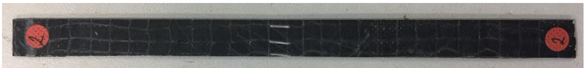
Figura 41 CP02 com orientação de 90°, após término do ensaio
