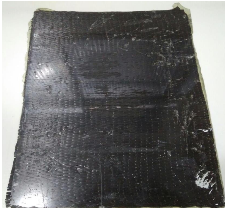
Figura 19 Segunda placa confeccionada, com o mesmo tipo de fibra da Placa I
