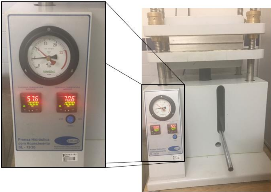
Figura 24 Prensa Hidráulica SL-12/20, com as configurações utilizadas em destaque
